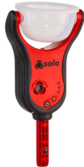
En utilisant l'adaptateur ASD, les systèmes d'aspiration peuvent également être testés rapidement.
