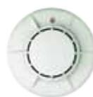
Le détecteur multicritères **ECO1002** dispose d'une chambre de mesure optique et d'une sonde thermique classe A1R, combiné avec un microprocesseur et des algorithmes avancés. La combinaison de caractéristiques optiques et thermiques accélère la réponse lors des situations d'incendie réelles, tandis que le risque de fausses alarmes, causées par l'environnement, est limité au strict minimum.
